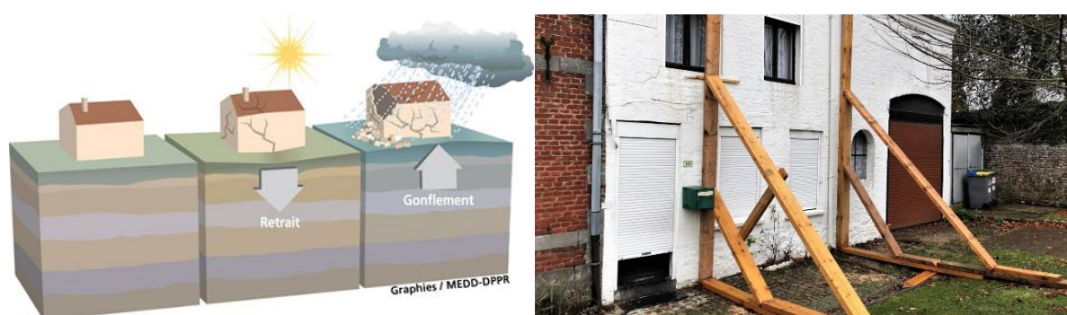
Figure 4 : le risque retrait-gonflement des argiles, préfecture du Nord, photo, la Voix du Nord
